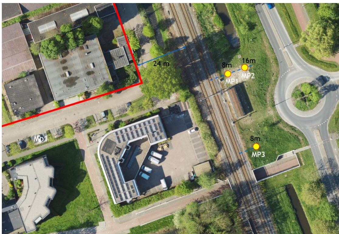
figuur 3: omgeving plan (rood omkaderd) met meetpunten Mp1 tot en met Mp3,
