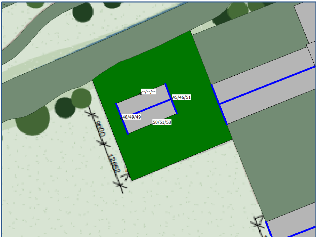
Afbeelding 5. Geluidbelastingen L_{den} (incl. aftrek art. 110g Wgh) N470 Berekende geluidbelastingen op een hoogte van 1,5 / 4,5 / 7,5 meter
