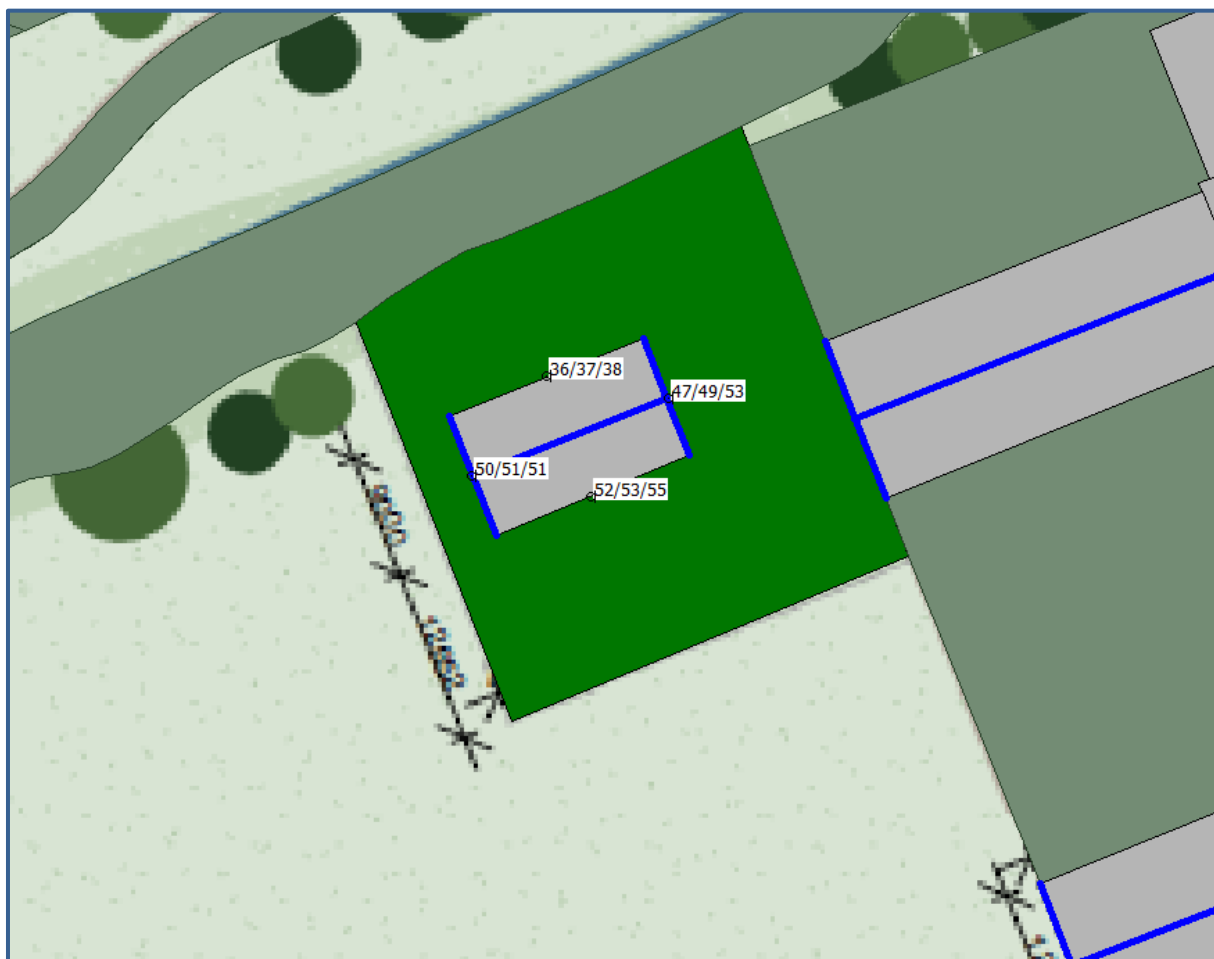
Afbeelding 7. Geluidbelastingen Lden (excl. aftrek art. 110g Wgh) cumulatief Berekende geluidbelastingen op een hoogte van 1,5 / 4,5 / 7,5 meter
